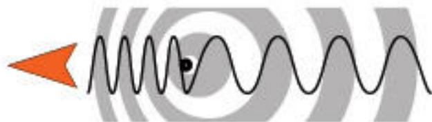
1.120. El efecto Doppler consiste en ondas que se comprimen al acercarse el objeto que las genera y se expanden al alejarse.
