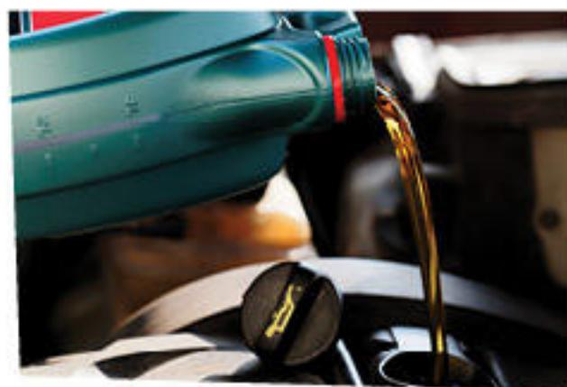
2.10. El aceite en el motor es indispensable para reducir la fricción entre las partes metálicas en movimiento.
