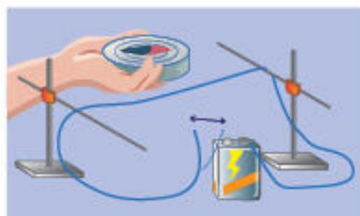
**1.36.** Cuando el circuito está abierto, no circula corriente eléctrica y la aguja de la brújula se orienta con el campo magnético terrestre. Cuando el circuito se cierra, circula la corriente eléctrica y la aguja de la brújula se desvía.
