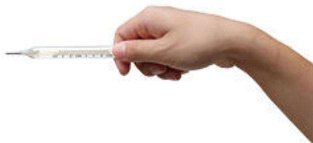
**2.30.** El mercurio se encuentra en el bulbo del termómetro. Cuando aumenta su temperatura sube por el interior de la varilla hasta mostrar un valor en la escala.
