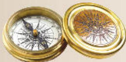
**1.2.** La brújula es una aguja imantada que gira sobre un eje y señala el norte magnético, por eso funciona como un instrumento de orientación.
