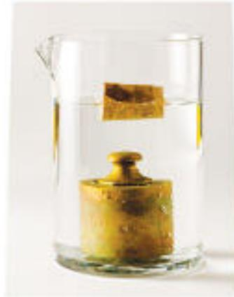
**1.78.** Representación del principio de Arquímedes: Un corcho flota en el agua y el metal se hunde debido a su densidad.
