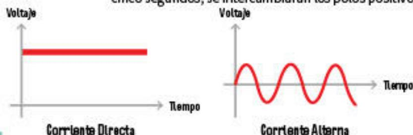
**2.79.** La gráfica de voltaje contra tiempo muestra que la corriente directa se comporta como una línea recta y tiene siempre un mismo valor, en cambio, la corriente alterna se aprecia como una onda, con un valor máximo positivo y un valor mínimo negativo.
