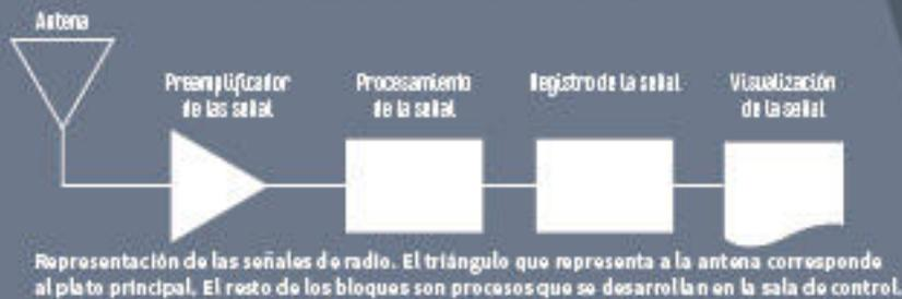
Las señales de radio emitidas por cualquier cuerpo estelar son procesadas y visualizadas mediante un equipo de cómputo y otros dispositivos electrónicos.
