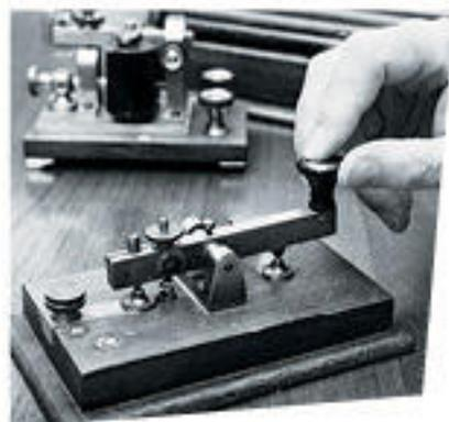
**1.105.** La máquina de telégrafo es una llave que se oprime y se suelta, alternativamente, para producir los impulsos eléctricos. Las palabras se transmiten mediante un código binario inventado por Samuel Morse (1791-1872). Este código es conocido como "clave Morse".
