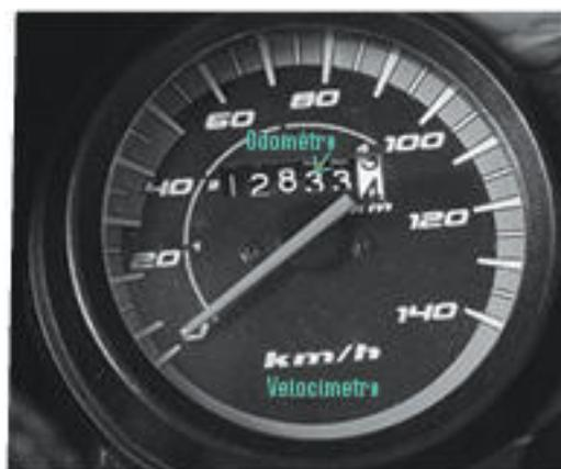
1.86. Las unidades del velocímetro son kilómetros por hora (km/h); las unidades del odómetro son kilómetros (km).
